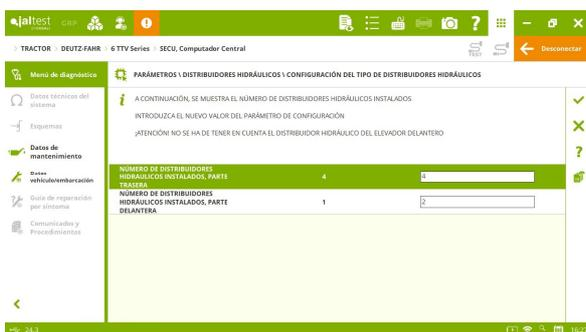
Computador central **SECU**, funciones de configuración de los parámetros de los distribuidores hidráulicos para los modelos **6C Series, 6 TTV Series, 7 Series, 8 TTV Series** y **9 Series**, entre otros.
